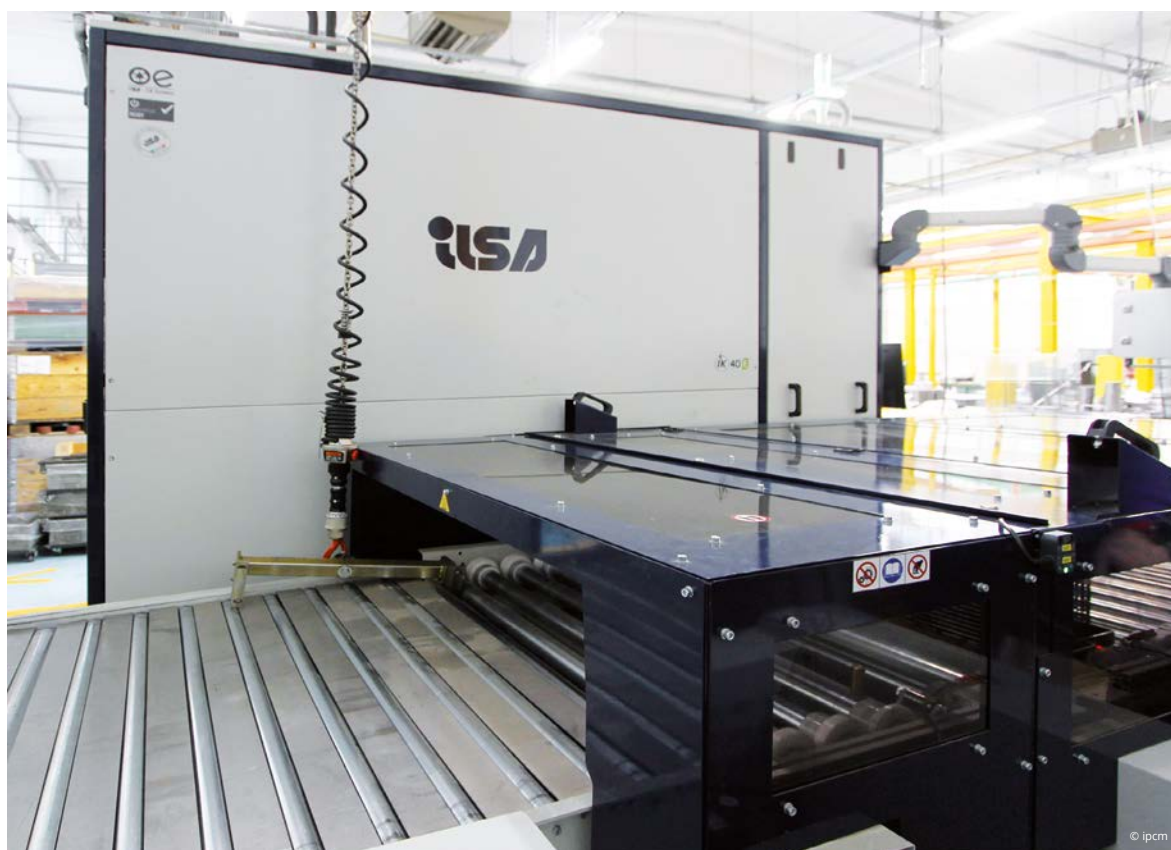
L'impianto di lavaggio di ILSA-MC IK40-e.
