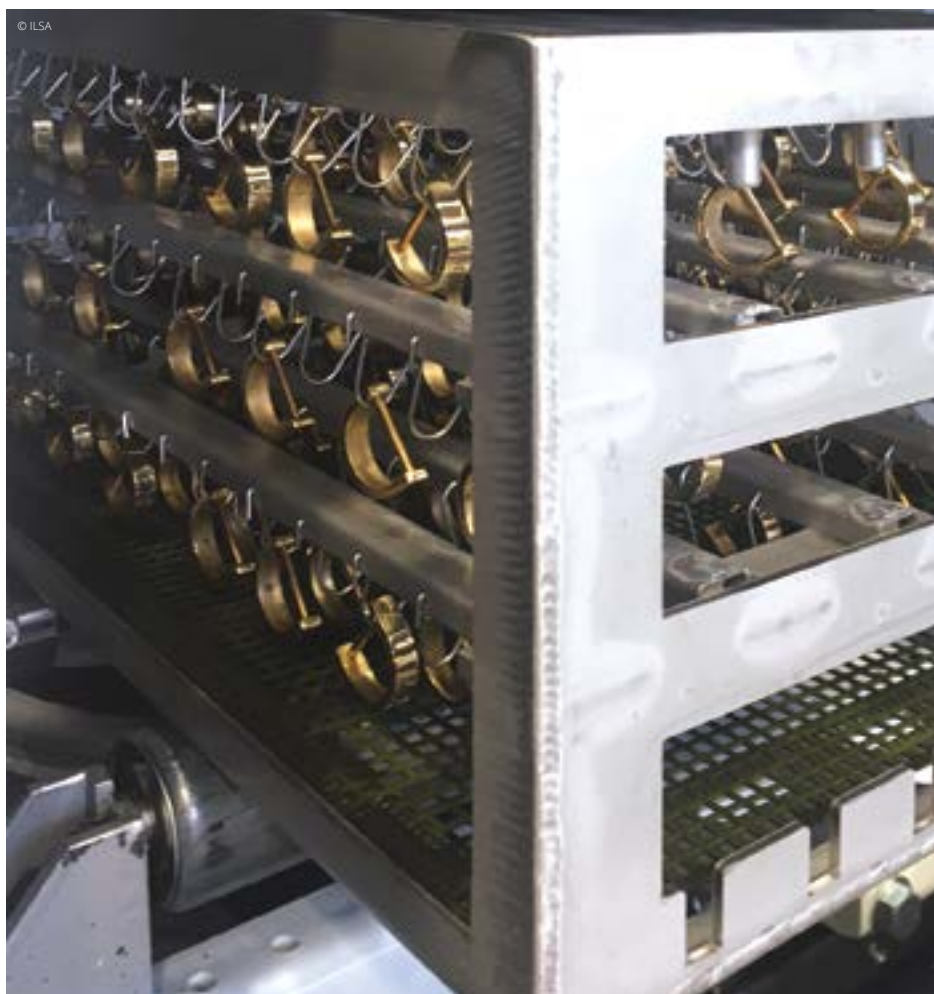
The two frame configurations for arranging the workpieces, created specifically for Arcos. Le due configurazioni dei telai per il posizionamento dei pezzi, creati appositamente per Arcos.
