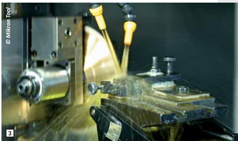
3 A fase de retífica das barras cilíndricas de carboneto, que dá à ferramenta a sua forma geométrica através da remoção progressiva de material.
