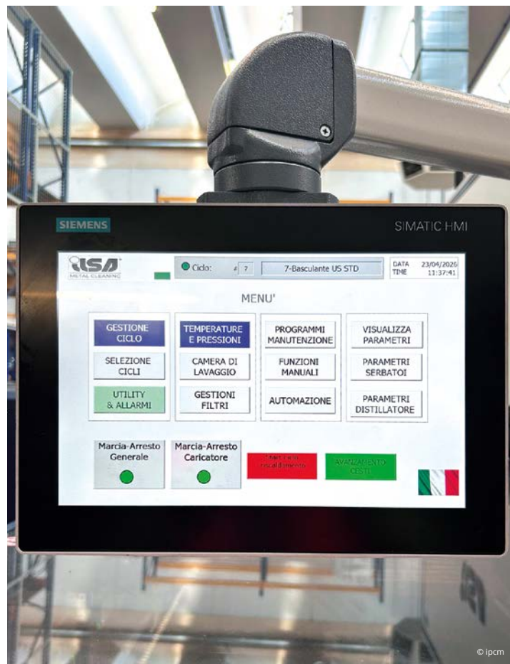
Touch-screen della macchina. Ogni carico può essere abbinato a cicli di lavaggio differente a seconda delle specifiche delle componentistiche.
