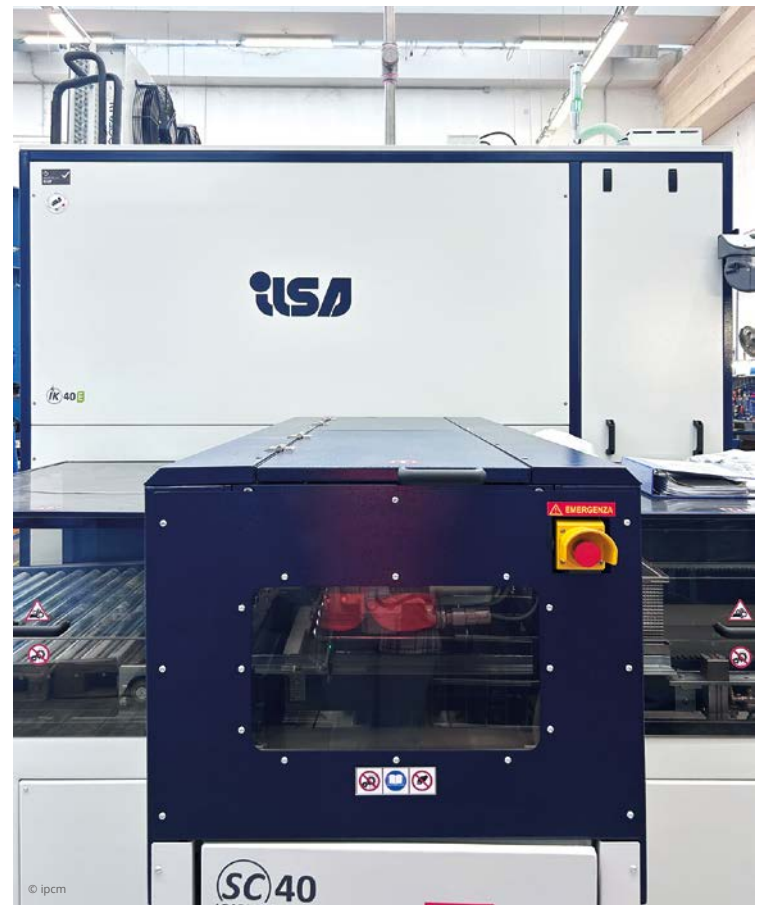
L'impianto di lavaggio a circuito chiuso, funzionante in vuoto e ad alcool modificato, progettato e fornito da ILSA-MC.
