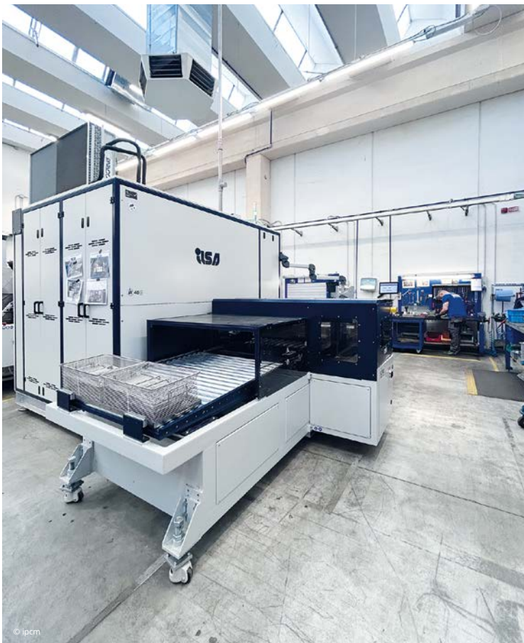
L'impianto di lavaggio a circuito chiuso, funzionante in vuoto e ad alcool modificato, progettato e fornito da ILSA-MC.
